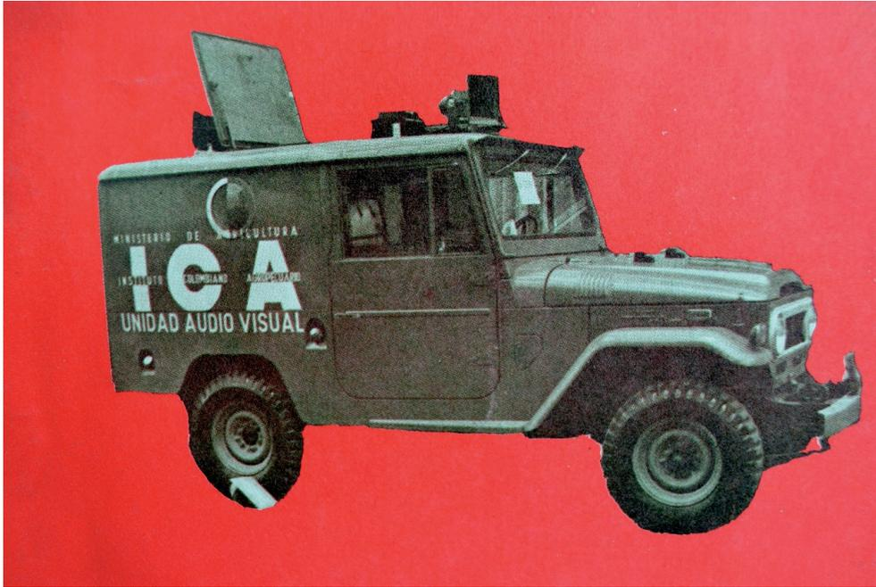
El equipo técnico para estas travesías estaba equipado por un jeep dotado de una planta generadora de energía, un proyector de diapositivas de 35 mm., un amplificador de sonido, un proyector de sonovisos de 35 mm., y un proyector de cine de 16 milímetros. Con estos elementos el gobierno colombiano profundizaba sobre un aspecto que ya tenía antecedentes desde los años treinta, así que su vínculo con el cine, la educación, y la alfabetización, estaba acorde las necesidades del momento.
