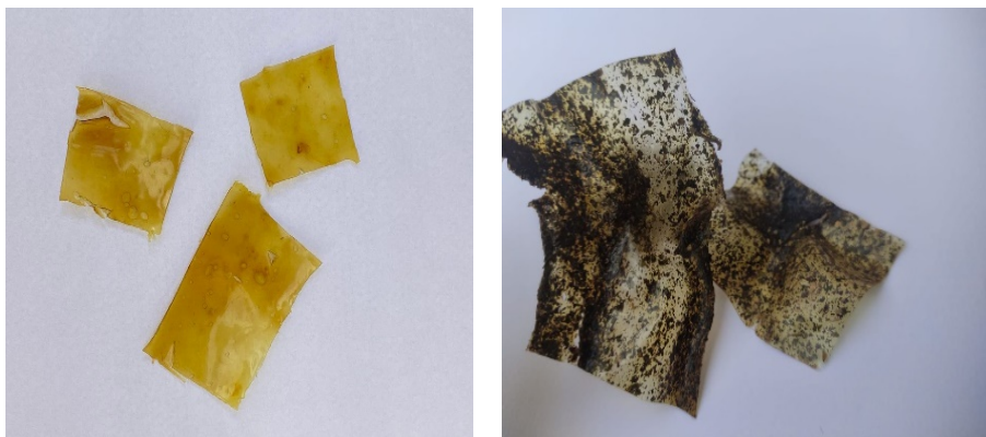
Figura 2- Os dois protótipos finais do bioplástico produzido com as folhas de feijão
