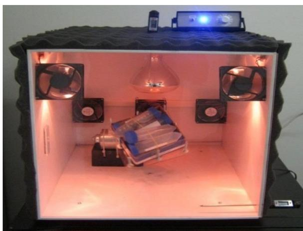
**Figura 1.** Aparelho utilizado nos experimentos em tanque agitado, que de acordo com o método do banho finito, proporciona um controle de agitação e temperatura.
