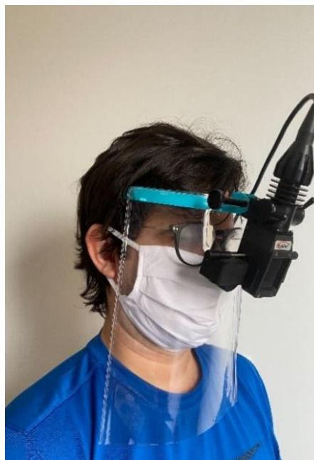
Fig. 6 Protótipo de protetor facial acoplado em OBI da marca EyeTec (Fonte: Foto de arquivo pessoal dos autores)
