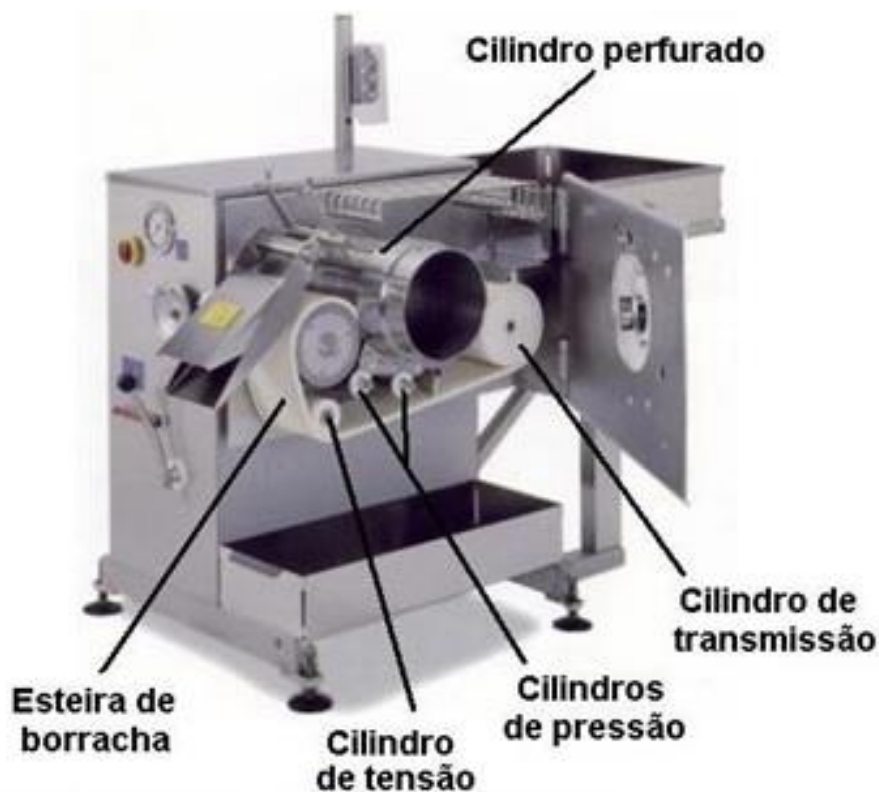
FIGURA 6. Separadora de ossos Belt-and-drum ou tambor rotatório feito de aço inoxidável (Adaptado de Kotaki ,2005).
